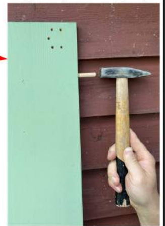
5. Holzdübel in Rückwand einschlagen (Packung D)
